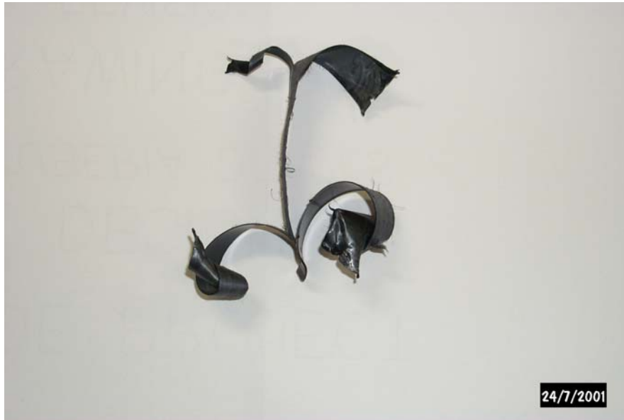
FOTO 2: 2.0 mm HDPE con separación de forro-núcleo
