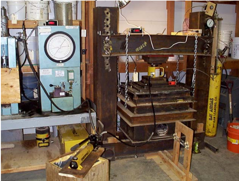
Foto 1: Equipo de Ensayos de Deflección de Tuberías
